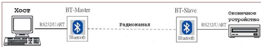
Рис. 1. Использование Bluetooth-модулей для замены кабельного соединения RS232
